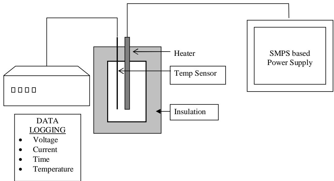
**BLOCK DIAGRAM : NANO FLUID HEAT CAPACITY APPARATUS**
